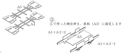
③で作った枠を裏返し、②で作った台枠を固定します。そしてステップ(A 6)を取り付けます。なお、ステップを先に②の枠にはめてから③の台枠を端から差し込む様に入れると、中心が楽に出ます。
