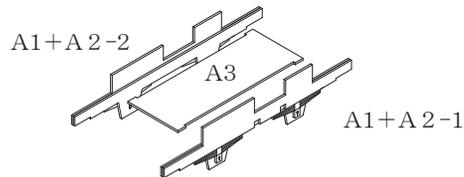
④、③で作った枠を裏返し、②で作った台枠を固定します。そしてステップ（A6）を取り付けます。なお、ステップを先に②の枠にはめてから③の台枠を端から差し込む様に入れると、中心が楽に出ます。
